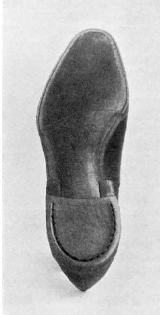
Fig.69. HEEL SEWN DOWN
